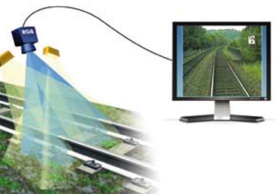
Prinzipieller Aufbau eines RailScan-Systems
