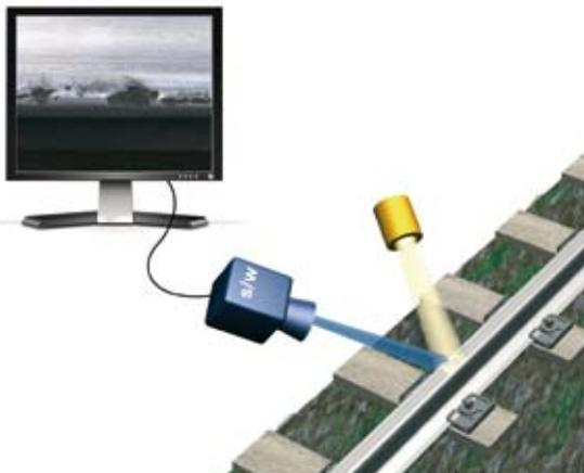
Prinzipieller Aufbau eines HeadCheck-Systems
